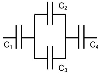
Kva er ekvivalentkapasitansen til kretsen av kondensatorar i figuren over, når  $C_1 = C_2 = C_3 = C_4 = 10 \mu\text{F}$ ?
