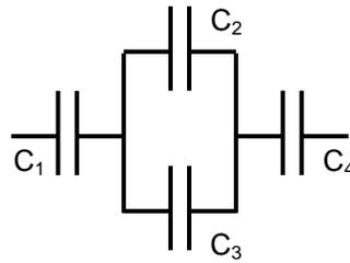
Hva er ekvivalentkapasitansen til kretsen av kondensatorer i figuren over, når  $C_1 = C_2 = C_3 = C_4 = 10 \mu\text{F}$ ?
