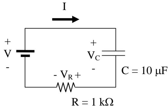
Ein spenningskilde på  $V = 30,0 \text{ V}$  (DC) i RC-krinsen over, slås på ved tida  $t = 0$ . Ved  $t=0$  er kondensatoren utlada. Skissér korleis straumen gjennom motstanden, ladningen på platene i kondensatoren, og spenninga over kondensatoren varierer med tida for  $t > 0$ . Angi tidskonstanten  $\tau$ , og størrelsen på straum, ladning og spenning ved tida  $t = \tau$  i forhold til maksimalverdiane, i plotta.
