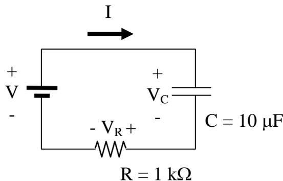
En spenningskilde på  $V = 30,0 \text{ V}$  (DC) i RC-kretsen over, slås på ved tiden  $t = 0$ . Ved  $t=0$  er kondensatoren utladet. Skissér hvordan strømmen gjennom motstanden, ladningen på platene i kondensatoren, og spenningen over kondensatoren varierer med tiden for  $t > 0$ . Angi tidskonstanten  $\tau$ , og størrelsen på strøm, ladning og spenning ved tiden  $t = \tau$  i forhold til maksimalverdiene, i plottene.
