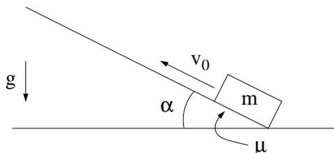
En kasse sendes i vei med starthastighet  $v_0$  oppover et skråplan. Kassen har masse  $m$ , skråplanet danner en vinkel  $\alpha$  med horisontalen, og friksjonskoeffisienten mellom kasse og skråplan er  $\mu$ . Vi antar for enkelhets skyld at statisk og kinetisk friksjonskoeffisient er like store.
