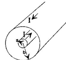
En koaksialkabel består av en hul innerleder med radius a og en tynn ytterleder med radius b. Du kan for begge lederne se bort fra veggtykkelsen. Lengden er lik S. Isolasjonsmaterialet mellom lederne har permeabilitet  $\mu_0$ . Magnetisk feltstyrke mellom lederne er  $H_\phi(r) = I/(2\pi r)$  når strømmen i lederne er +I og -I og r = avstand fra aksene.
