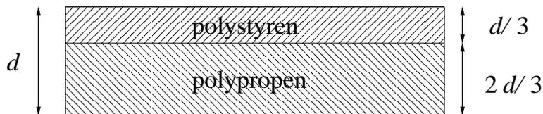
Platene har areal  $A = 50 \text{ cm}^2$  og innbyrdes avstand  $d = 3 \text{ mm}$ . Polystyren har relativ permittivitet  $\epsilon_{r1} = 2.5$ , polypropen har relativ permittivitet  $\epsilon_{r2} = 3.0$ . Oppgi svaret i enheten pF. (1 pF =  $10^{-12} \text{ F}$ )
