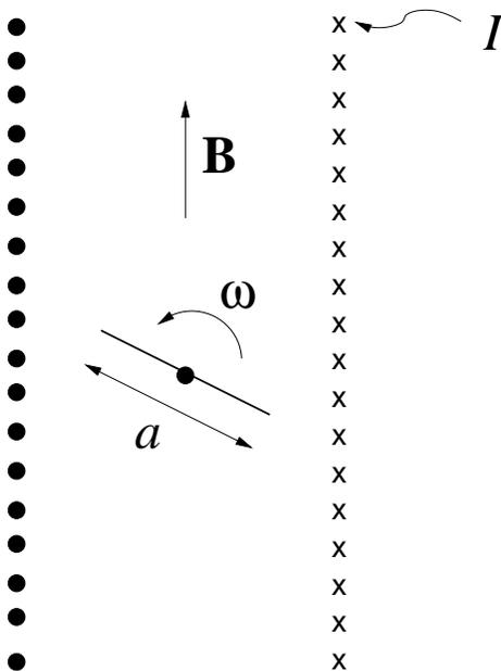
I figuren ser vi et snitt gjennom sentrum av spolen, der  $\times$  angir strøm inn i planet og  $\bullet$  angir strøm ut av planet. Inne i spolen ser vi den ene sidekanten av den roterende ledersløyfa.
