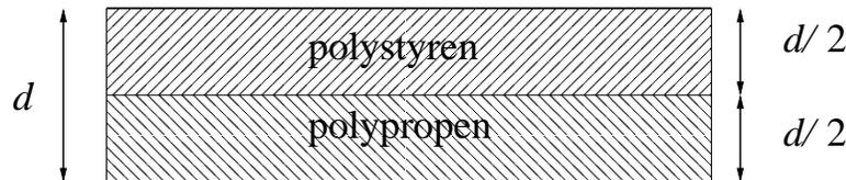
Platene har areal  $A = 25 \text{ cm}^2$  og innbyrdes avstand  $d = 2 \text{ mm}$ . Polystyren har relativ permittivitet  $\epsilon_{r1} = 2.5$ , polypropen har relativ permittivitet  $\epsilon_{r2} = 3.0$ . Oppgi gjerne svaret i enheten pF. (1 pF =  $10^{-12} \text{ F}$ )
