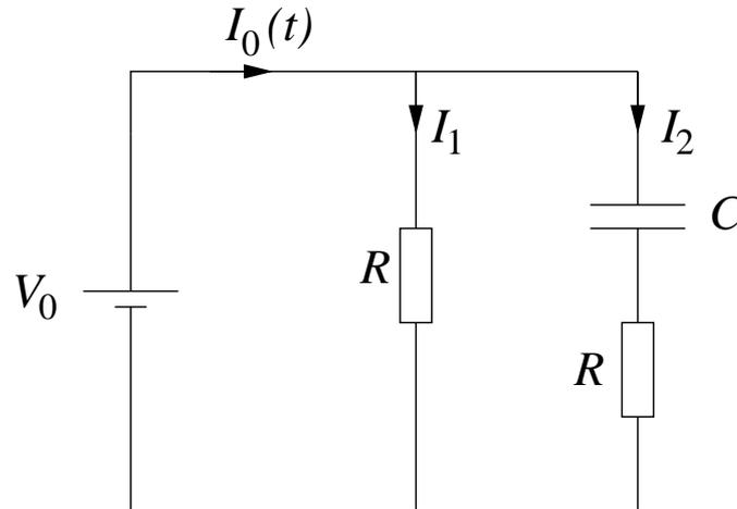
Anta at spenningskilden  $V_0$  kobles til kretsen ved tidspunktet  $t = 0$ . Vi antar videre at det er null ladning på kondensatoren før tilkobling av  $V_0$ . Umiddelbart etter tilkobling "leverer" spenningskilden en strøm  $I_0(0)$ . Ved stasjonære forhold ( $t \rightarrow \infty$ ) leverer spenningskilden en strøm  $I_0(\infty)$ . Bestem strømmen  $I_0(t)$ , og deretter forholdet
