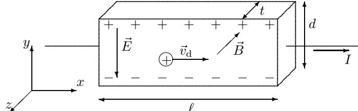
Proben brukes til å måle styrken på et magnetfelt  $B$  som antas homogent og rettet i  $-z$ -retning i koordinatsystemet vist i figuren. Figuren gir også noen nyttige opplysninger.
