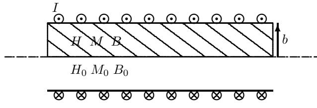
Figuren viser en solenoide med radius  $b = 30$  mm og vikingstall  $n = 800 \text{ m}^{-1}$ . Antall viklinger er altså mye større enn 10 som er brukt i figuren. Strømmen  $I = 3,50 \text{ A}$ . Et jernmateriale med relativ permeabilitet  $\mu_r = 2000$  fyller halve solenoiden, resten er luftfylt. Jernet har metningsmagnetisering  $M_s = 1,56 \cdot 10^6 \text{ A/m}$ . Senteraksen til solenoiden er i figuren vist med halvstiplet linje.
