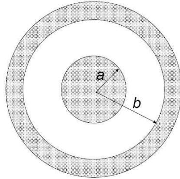
a) Bruk Gauss' lov til å finne det elektriske feltet  $\vec{E}$  som funksjon av  $r$  for  $a < r < b$ , uttrykt ved bl.a.  $\lambda$  og  $\epsilon_0$ .
