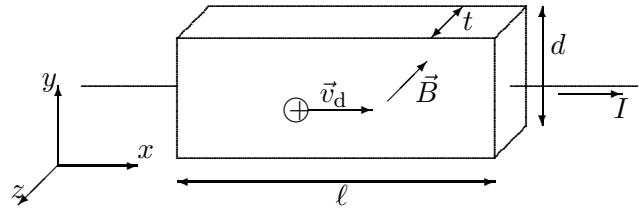
Proben brukes til å måle styrken på et magnetfelt  $B$  som antas homogent og rettet i  $-z$ -retning i koordinatsystemet vist i figuren. Figuren viser også ladningbærernes driftsfart  $v_d$ .
