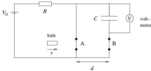
(Et voltmeter måler rett og slett potensialforskjellen mellom to punkter i en krets uten å påvirke kretsen. Det går for eksempel ingen strøm gjennom et ideelt voltmeter.)
