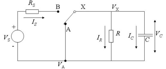
iv) Kondensatoren er ladet opp til konstant  $V_C$  slik at  $I_C = 0$ . Da er det bare motstandene som bestemmer  $V_C$ . Strømmen gjennom både  $R_S$  og  $R$  blir  $I_S = \frac{V_S}{R_S + R}$  og dermed
