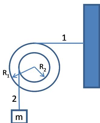
Ei trinse har indre radius  $R_2$  og ytre radius  $R_1$ . En masse  $m$  henger i et tau (2) som går over trinsa på et sted der radien er  $R_2$ . Trinsa er festet til en vegg med et horisontalt tau (1) på et sted der trinseradien er  $R_1$ . (Se figur.) Hva er snorkraften ( $S_1$ ) i det horisontale tauet når tyngdeakselerasjonen er  $g$ ?
