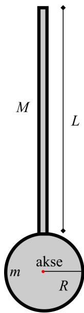
Bestem treghetsmomentet  $I$  til robotarma om rotasjonsaksen.
