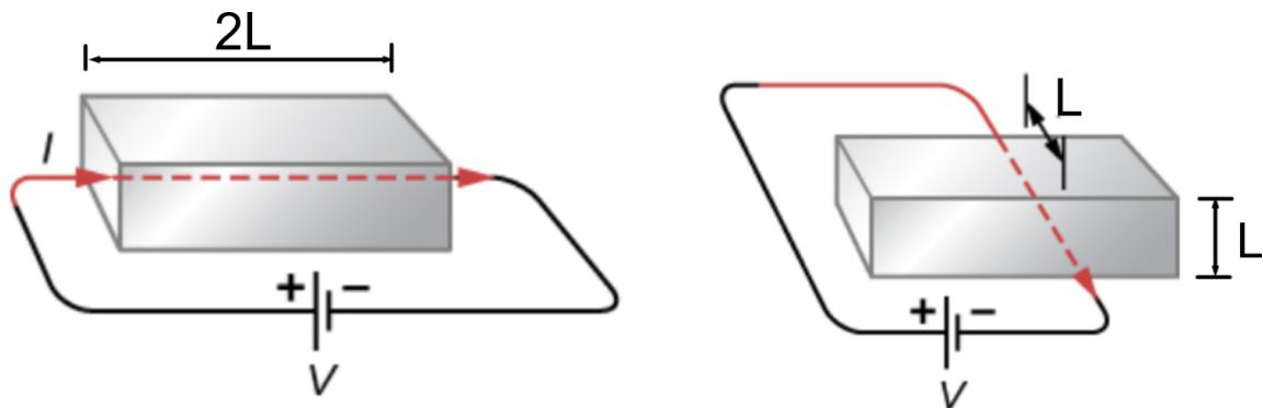
Motstanden er formet som en rektangulær kloss med sidelengden  $2L$  og endeflatene har sidelengder  $L$ .
