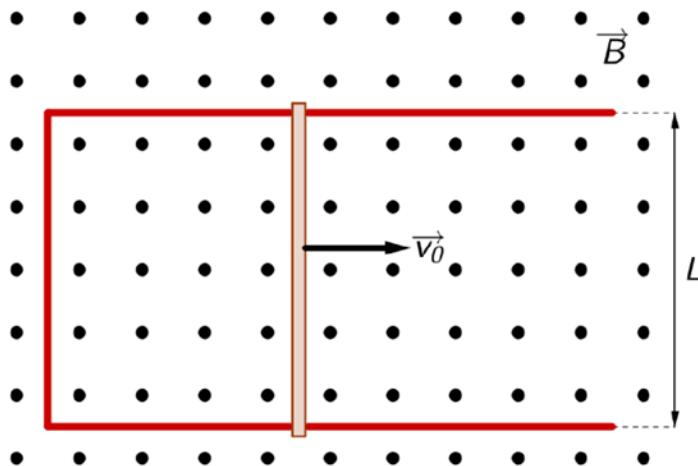
Størrelsen til det magnetiskefeltet er  $B = |\vec{B}| = 0,35 \text{ T}$ . Resistansen i kretsen er lik  $R = 0,20 \Omega$ . Lengden av staven er  $L = 0,40 \text{ m}$  og massen  $m = 0,10 \text{ kg}$ . Metallstaven settes i bevegelse slik at den får utgangsfarten  $v_0 = |\vec{v}_0| = 1,2 \text{ m/s}$  mot høyre.
