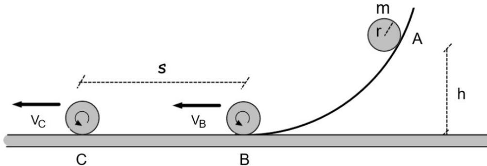
Ei massiv kule med masse  $m = 3,5 \text{ kg}$  og radius  $r = 0,20 \text{ m}$  er plassert på en sirkulært formet bane (punkt A) i en høyde  $h = 2,5 \text{ m}$  over bakken. Kula holdes i ro før den slippes. På veien nedover mot punkt B virker det friksjonskretfer mellom kula og underlaget slik at den ruller uten å gli nedover langs banen (se figuren over).
