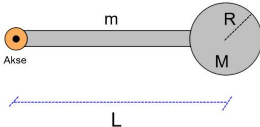
Et stivt legeme formet som en pendel består av ei massiv stang med ei massiv kule festet i den ene enden. Enden av stanga befinner seg i kulas sentrum. Kula har masse  $M = 1,50 \text{ kg}$  og radius  $R = 0,100 \text{ m}$ . Stanga har masse  $m = 2,30 \text{ kg}$  og lengde  $L = 0,800 \text{ m}$ . Denne stive pendelen er videre festet til en omdreiningsakse som står normalt på stanga, slik at den kan rotere friksjonsfritt i tyngdefeltet. Både stanga og kula har jevn massefordeling.
