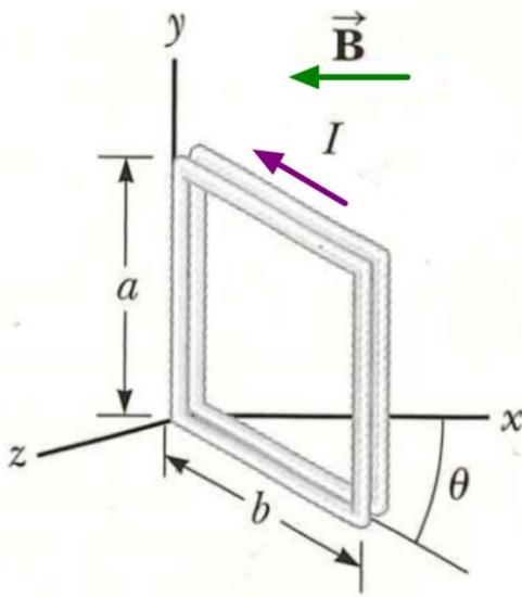
En rektangulær spole som består av 100 vindinger som ligger svært tett sammen, har sidekanter med lengder  $a = 40,0\text{ cm}$  og  $b = 30,0\text{ cm}$ . Spolen er hengslet fast til  $y$ -aksen og danner en vinkel  $\theta = 40,0^\circ$  med  $x$ -aksen. Anta at det går en strøm  $I = 2,20\text{ A}$  inne i sløyfa med retning som antydet i figuren over.
