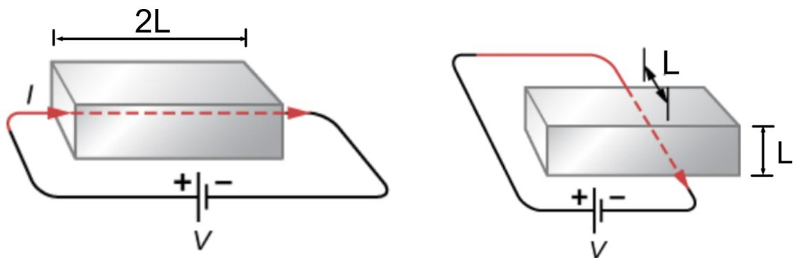
Motstanden er formet som en rektangulær kloss med sidelengden  $2L$  og endeflatene har sidelengder  $L$ .
