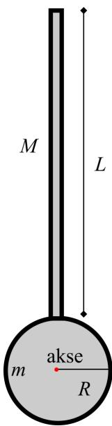
Bestem treghetsmomentet  $I$  til robotarma om rotasjonsaksen.
