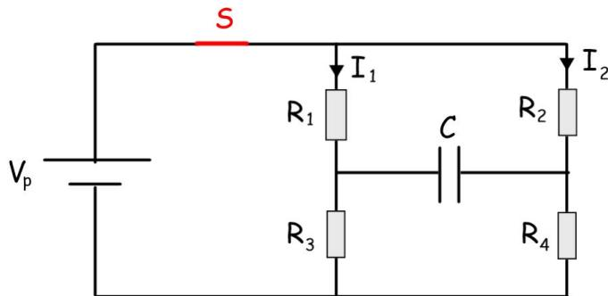
RC-kretsen i figuren over består av et batteri, fire motstander, en kondensator og en bryter. Spenningen over batteriet er  $V_p = 10 \text{ V}$ . Resistansen til hver av motstandene er henholdsvis  $R_1 = 1,0 \Omega$ ,  $R_2 = 8,0 \Omega$ ,  $R_3 = 4,0 \Omega$  og  $R_4 = 2,0 \Omega$ . Kapasitansen til kondensatoren er  $C = 1,0 \mu\text{F}$ . Vi antar at bryteren har vært lukket over så lang tid at kondensatoren har maksimal ladning  $Q$  lagret på platene.
