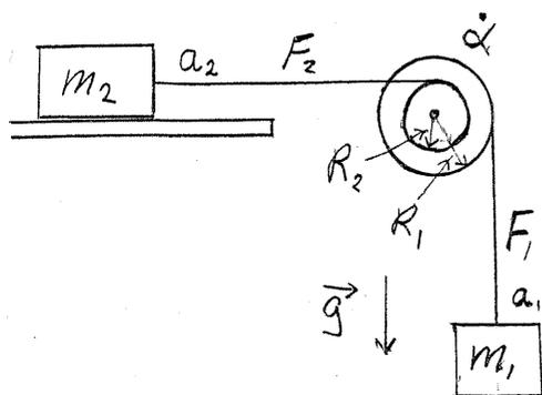
En masse  $m_1$  henger i et tau som går over ei trinse eller talje på et sted der radien er  $R_1$ . En annen masse  $m_2$  ligger på et horisontalt bord og er festet med et tau til den samme trinsa på et annet sted der radien er  $R_2$ , som vist på figuren. Massen  $m_2$  holdes først fast slik at systemet er i ro. Hva er da strekkene eller kreftene  $F_1$  og  $F_2$  i tauene når tyngdeakselerasjonen er  $g$ ?
