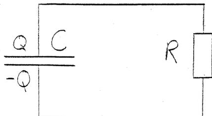
Den elektriske kretsen på figuren består av en kondensator eller kapasitans  $C$  koplet i serie med en motstand  $R$ . Sett opp differensiallikningen for kretsen. Denne likningen bestemmer ladingen  $Q$  på kondensatoren, og den har løsning av formen
