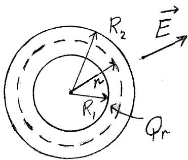
Ei kule med ytre radius  $R_2$  og indre radius  $R_1$  har en elektrisk ladning  $Q$ . Denne ladningen er jevnt fordelt mellom disse radiene. (Dvs. ladning pr. volumenhet er konstant.) Betrakt ei tenkt kuleflate i avstand  $r$  fra sentrum. Hvor stor ladning  $Q_r$  ligger innenfor radien  $r$  ( $R_1 < r < R_2$ )?
