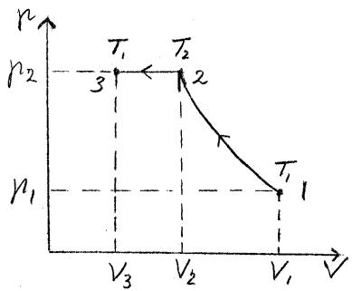
En ideell gass med adiabatkonstant  $\gamma = 1,4$  komprimeres adiabatisk fra trykket  $p_1$  til trykket  $p_2$  mellom punktene 1 og 2 på figuren. Deretter avkjøles gassen ved konstant trykk  $p_2$  til punkt 3 der temperaturen er tilbake til starttemperaturen  $T_1 = 290 \text{ K}$  i punkt 1.
