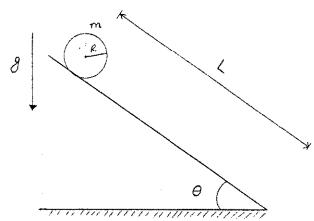
Et legeme med masse  $m$  og radius  $R$  ruller uten å skli på et skråplan med lengde  $L$  som danner en vinkel  $\theta$  med horisontalplanet (se figur). Legemets treghetsmoment for dreining rundt rotasjonsaksen når det ruller, er oppgitt å være  $I = \beta mR^2$ . Et tyngdefelt virker loddrett nedover (se figur).
