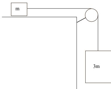
7) To masser  $m$  og  $3m$  er festet i hver sin ende av ei (stram) snor som går over ei trinse. Snor og trinse kan regnes som masseløse, og vi ser bort fra friksjon. Hva er klossenes akselerasjon?
