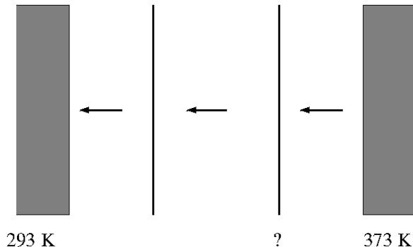
Platene har en lineær utstrekning som er mye større enn avstanden mellom dem, slik at varmestrømmen kan regnes som endimensjonal, som antydet i figuren.
