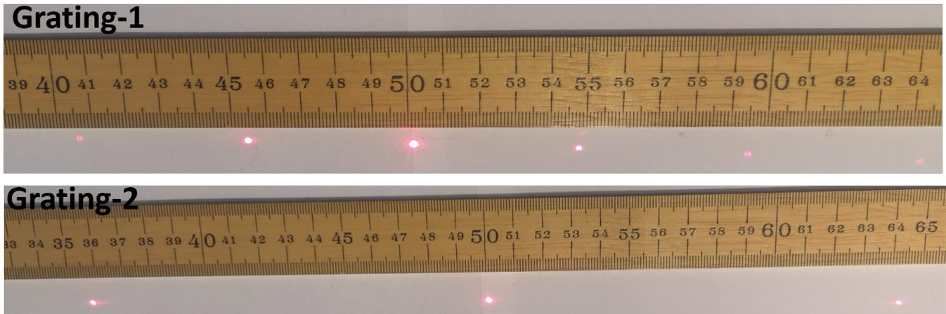
Gitter 1 (Grating-1) har en kjent avstand mellom metallstripene (oppgitt 100 striper per mm), mens her skal gitteravstanden til gitter 2 (Grating-2) bestemmes. (Zoom gjerne inn på figuren hvis det er vanskelig å se). Gitteravstanden til gitter 2 er:
