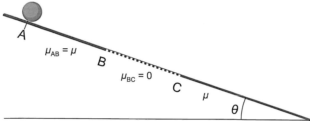
Ei kompakt kule med masse  $m$  og radius  $r$  settes på et skråplan med hellingsvinkel  $\theta$  ved punktet merket A. Kula har i utgangspunktet A translasjonshastighet  $v_A = 0$  m/s og rotasjonshastighet  $\omega_A = 0$  rad/s, dvs. kula er i ro. Mellom punktene A og B, en distanse  $s$ , er friksjonskoeffisienten mellom kula og underlaget  $\mu$ , som er tilstrekkelig stor til at kula ruller uten å skli.
