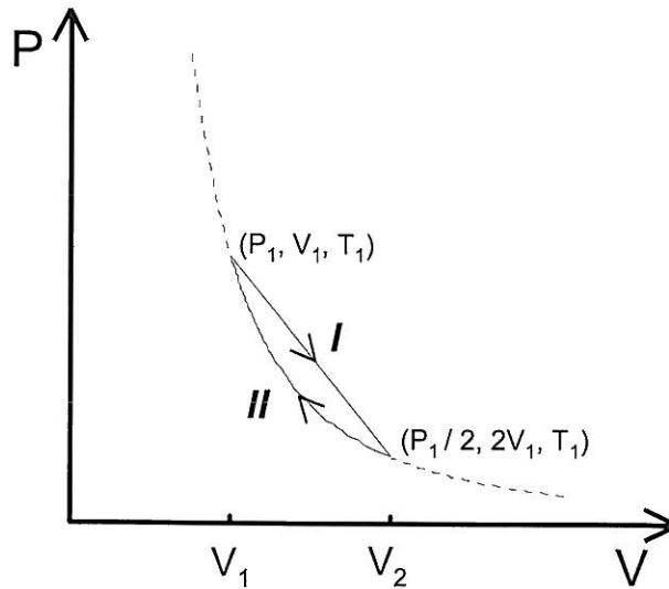
En totrinns reversibel prosess for en ideell gass består av *I*: en rett linje fra tilstanden  $(P_1, V_1, T_1)$  til tilstanden  $(\frac{1}{2}P_1, 2V_1, T_1)$ , og *II*: en isoterm kompresjon tilbake til utgangstilstanden, som vist i figuren.
