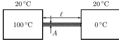
Staven har varmeisolerte sidevegger slik at staven utveksler varme kun med de to reservoarene i hver ende. Reservoarene derimot er ikke fullstendig isolert fra omgivelsene slik at de i tillegg til varme gjennom kopperstaven også utveksler varme med omgivelsene ved varmeledning/varmeovergang.
