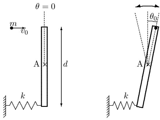
Ei tynn stang har lengde  $d$  og masse  $M$  (venstre figur). Stanga kan rotere friksjonsfritt om en akse (A) på midten. Til den nederste enden (i avstand  $d/2$  fra A) er festet ei horizontal fjær med fjærkonstant  $k$ . Stanga er i utgangspunktet i likevekt ( $\theta = 0$ ).
