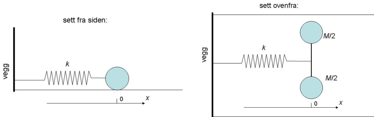
**a.** Anta først at kulene glir friksjonsfritt på underlaget. På grunnlag av Newtons 2. lov finn systemets bevegelseslikning, gjenkjenn denne som en udempet harmonisk svingning og finn herfra svingetida  $T_0$  i sekunder.
