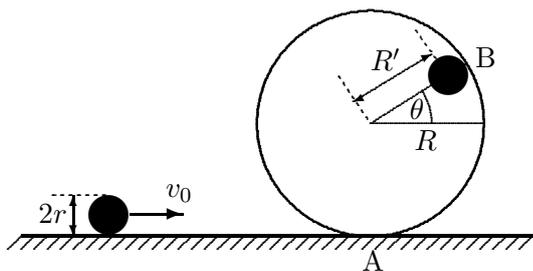
**c.** Ved neste forsøk reduseres utgangshastigheten til  $v_0 = 2,50$  m/s. Kula vil nå miste kontakten med underlaget i en posisjon B før den når toppunktet. Figuren viser denne posisjonen definert med vinkel  $\theta$  med horisontalen. Finn denne vinkelen  $\theta$ .
