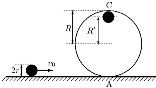
Ei massiv kule med radius  $r = 4,00$  cm og masse  $m = 150$  g ruller med hastighet  $v_0 = 3,00$  m/s på et horisontalt underlag inn mot en "loop" med radius  $R = 24,0$  cm. Det er under rullingene ingen energitap pga. kinetisk friksjon ("tapsfri" rulling).
