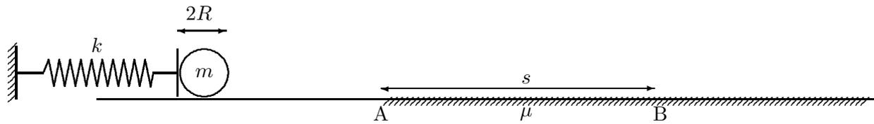
Ei kule med masse  $m = 0,500$  kg og radius  $R = 5,00$  cm settes i fart med ei spent fjær med fjærkonstant  $k$ . Fjæra er før utskytinga klempt sammen  $b = 4,00$  cm fra likevektsstilling og dette gir umiddelbart etter utskytinga kula en fart  $v = 1,40$  m/s mot høyre.
