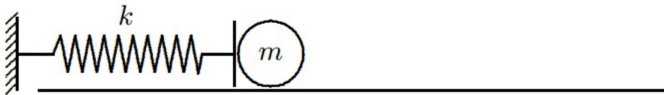
Ei kule med masse 42 g ligger på et horisontalt friksjonsfritt bord inntil ei ideell masseløs fjær. Fjæra er i utgangspunktet presset sammen 42 mm fra sin likevektslengde. Fjæra løses ut slik at kula akselererer mot høyre. Kulas hastighet når den forlater fjæra, dvs i det fjæra når sin likevektslengde, er 42 cm/s. Hva er fjæras fjærkonstant, i enheten N/m?
