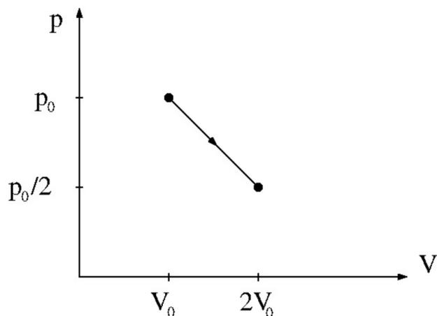
En ideell gass utvider seg reversibelt fra en tilstand med trykk og volum hhv  $p_0$  og  $V_0$  til en tilstand med dobbelt så stort volum og halvparten så stort trykk. Prosessen foregår som skissert i figuren. Hvor stor er gassens entropiendring pr mol?
