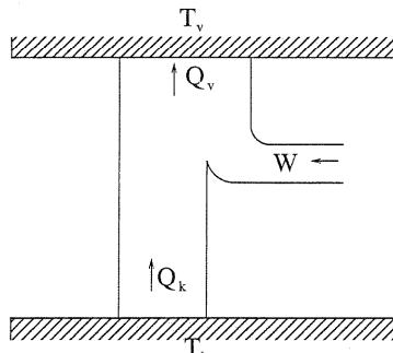
a. Effektfaktoren for varmepumper defineres rimeligvis som forholdet mellom gevinsten, i form av varmemengden  $|Q_v|$  levert til stua ved temperaturen  $T_v$ , og kostnaden, i form av det elektriske arbeidet  $W$  som går med i prosessen. Altså,  $\eta = |Q_v|/W = |Q_v|/(|Q_v| - |Q_k|)$ . At  $W = |Q_v| - |Q_k|$ , der  $|Q_k|$  er varmemengden trukket ut av lavtemperaturreservoaret, er en direkte følge av varmelærrens første lov (eller: energibareelse).
