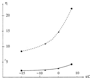
b. Effektfaktoren i den kommersielle varmepumpen er skissert heltrukket i figuren til venstre, mens det tilsvarende Carnotresultatet er stiplet. (Husk at det er absolutt-temperaturer som inngår i Carnot-formelen, ikke Celsius-temperaturer!) Figuren viser at temperaturavhengigheten til den kommersielt tilgjengelige pumpen er noenlunde tilsvarende den idealiserte Carnot-prosessens avhengighet av ute temperaturen  $T_k = 273 + t$ .
