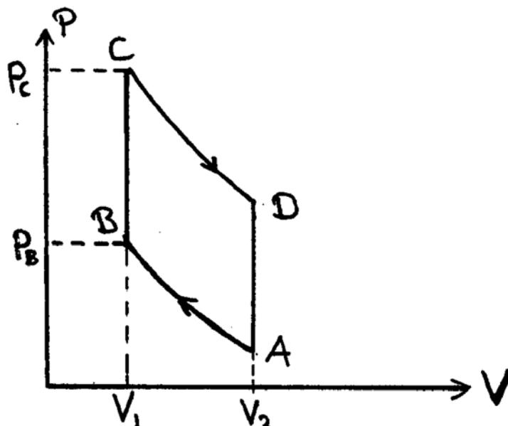
En reversibel kretsprosess ABCDA er sammensatt av to adiabatiske og to isokore prosesser som vist i figuren. Volumene  $V_1$  og  $V_2$  er gitt.
