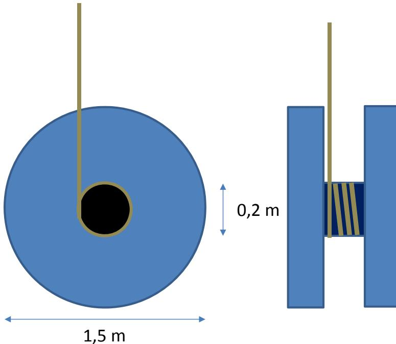
En kjempestor yo-yo med masse  $M = 40 \text{ kg}$  og diameter  $1,5 \text{ m}$  slipper fra et høyt tårn. Den ene enden av den  $50 \text{ m}$  lange snora er festet til toppen av tårnet, den andre er viklet rundt en aksling med diameter  $0,2 \text{ m}$ . Anta at massen til yo-yo'en er jevnt fordelt i de to store skivene, og at snora og akslingen er masseløse.
