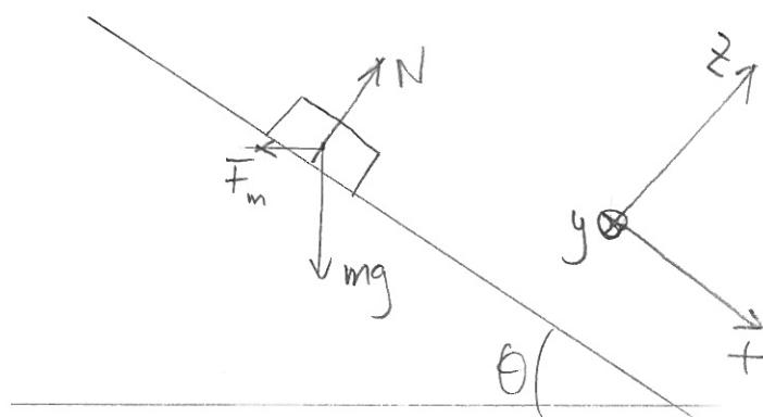
Normalkraft, tyngdekraft og magnetisk kraft virker på klossen.
