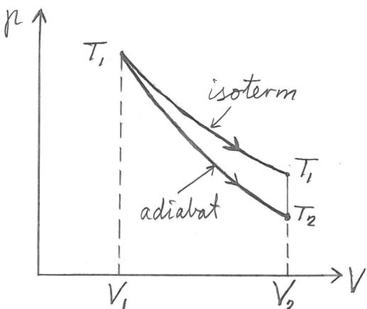
Van der Waals gassen skal ekspandere fra volumet  $V_1$  til volumet  $V_2$ . Dette kan gjøres på 2 måter, som vist på figuren. Den ene måten er å følge isolermen  $T = T_1$ . Beregn arbeidet  $W_1$  langs denne isolermen.
