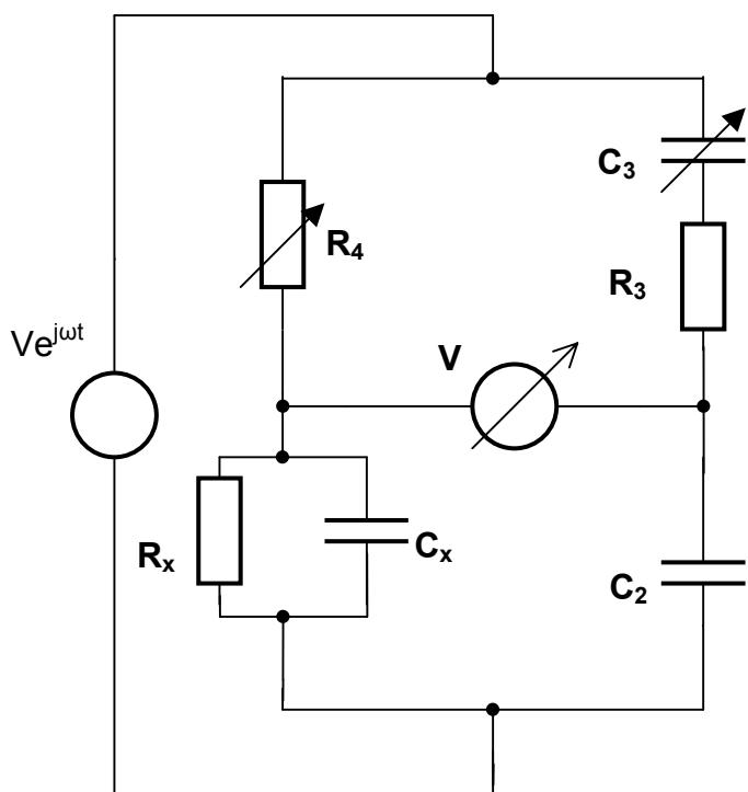
Til venstre er vist en brukoppling som blir eksitert med en vekselspenning med frekvens  $\omega$ .
