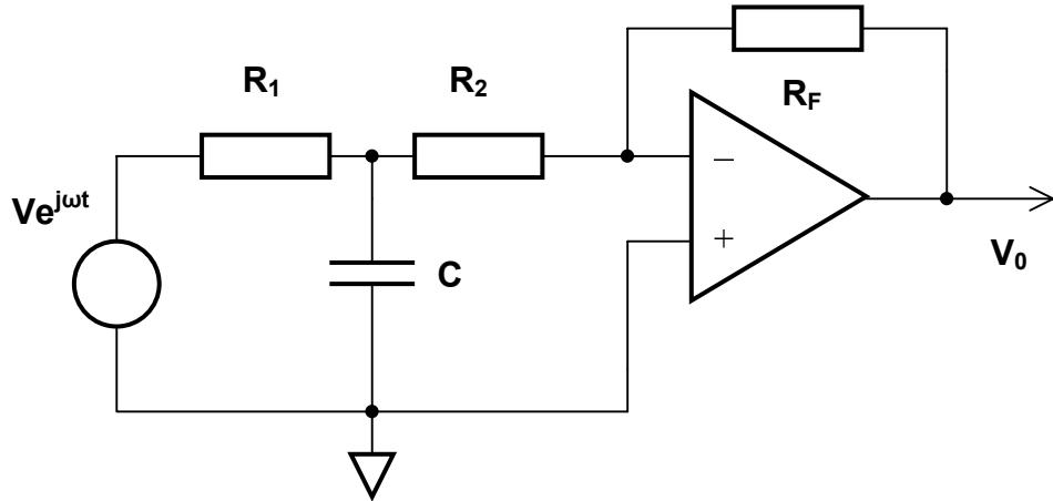
Figuren viser en ideell operasjonsforsterker med tilbakekoplingsmotstand  $R_F$ . Inngangskretsen består av motstandene  $R_1$ ,  $R_2$  kondensatoren  $C$  og en spenningskilde med amplitude  $V$  og frekvens  $\omega$ .
