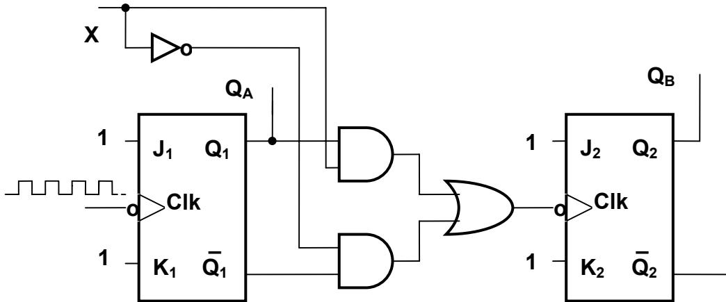
Figuren viser en 2-bits asynkron teller som ble brukt i prosjektet på laboratoriet, og i tillegg med en logisk krets med en inverter, to OG-porter og en ELLER-port mellom utgangen av den ene JK-vippa og klokkeinngangen på den neste.
