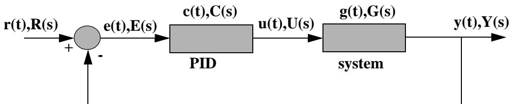
Figuren over viser eit system som er styrt ved bruk av ein PID-regulator.
