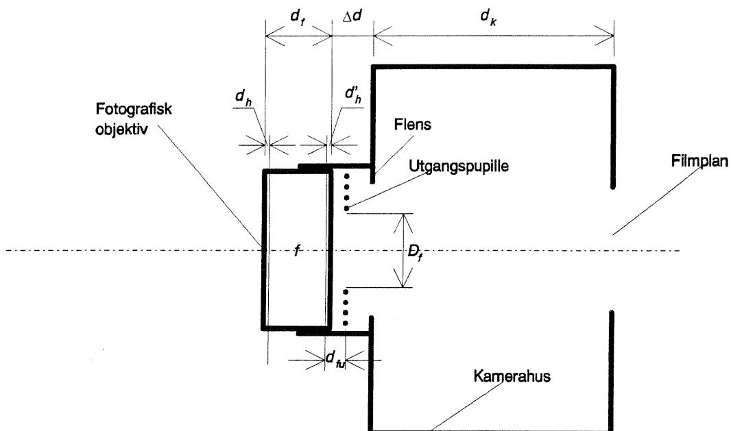
Fokusering foregår ved at objektivet forflyttes frem og tilbake. Objektivets bakkant kan maksimalt forflyttes opp til  $\Delta d=10$  mm fra kamerahusets flens.
