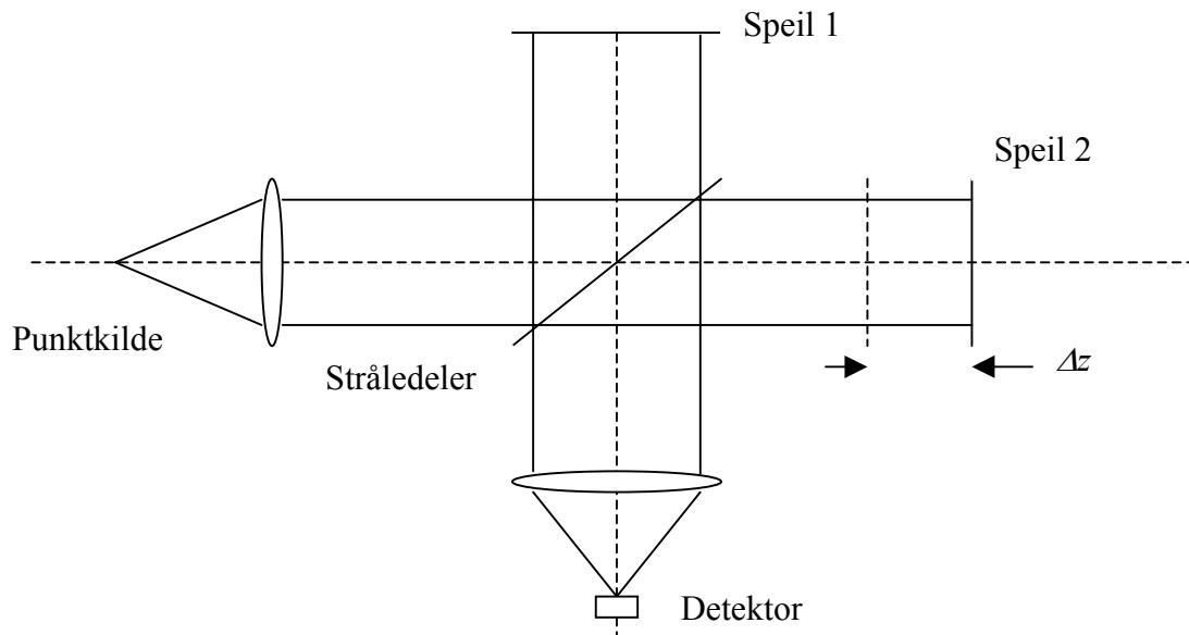
Figuren viser skjematisk et Michelson-interferometer med kollimert punktkildebelysning. Vi antar at de to interfererende bølgene har samme intensitet, og at interferometeret er perfekt oppjustert. Den detekterte intensiteten varierer da bare med gangforskjellen  $s = 2\Delta z$ , hvor  $\Delta z$  er forskyvningen av speil 2 fra posisjonen med null gangforskjell.
