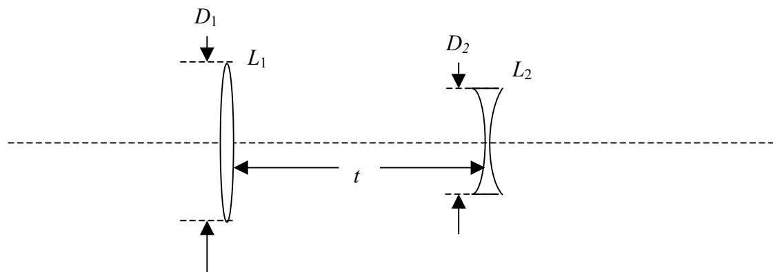
Figuren viser et sammensatt system som består av to tynne linser i luft ( $n = 1$ ): En positiv linse  $L_1$  og en negativ linse  $L_2$  med fokallengder, henholdsvis,  $f_1 = 15 \text{ cm}$  og  $f_2 = -3 \text{ cm}$ , og med innbyrdes avstand  $t$ .
