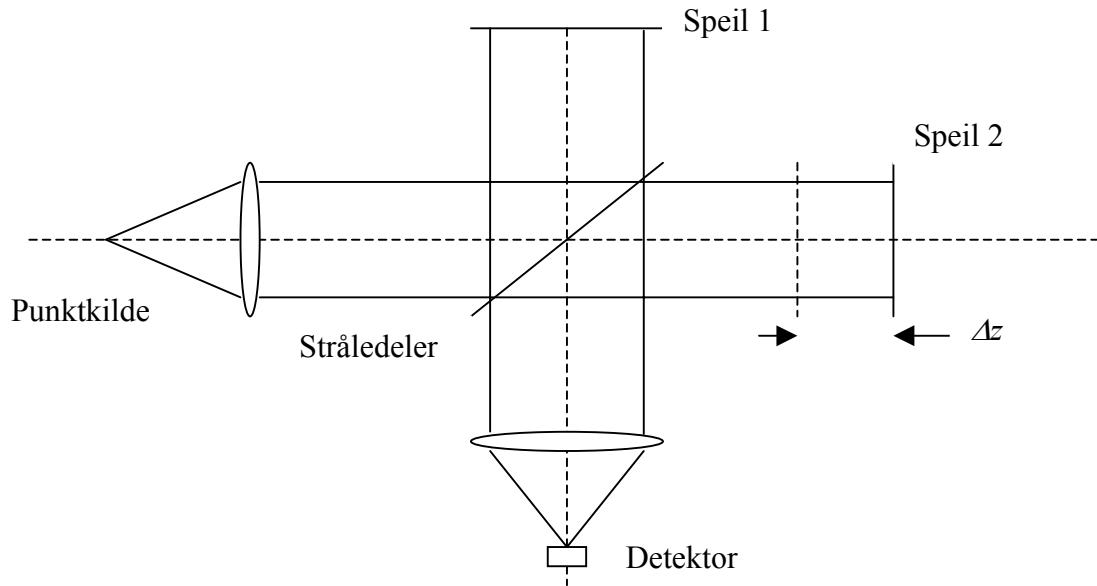
Figuren viser skjematisk et Michelson-interferometer med kollimert punktkildebelysning. Vi antar at de to interferererende bølgene har samme intensitet, og at interferometeret er perfekt oppjustert. Den detekterte intensiteten varierer da bare med gangforskjellen  $s = 2\Delta z$ , hvor  $\Delta z$  er forskyvningen av speil 2 fra posisjonen med null gangforskjell.
