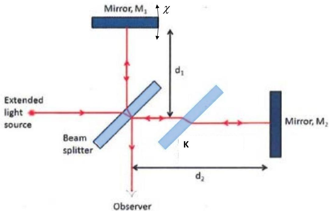
Et Michelson-interferometer er skissert i figuren. Hva er hensikten med det optiske elementet K? Vi antar at interferometeret er justert slik at observatøren ser sirkulære interferensmønster, at  $d_1 \approx d_2$ , og at det brukes monokromatisk lys. Når  $M_1$  forflyttes 314,2 mikrometer, telles 850 passerende interferensbånd. Hva er bølgelengden?
