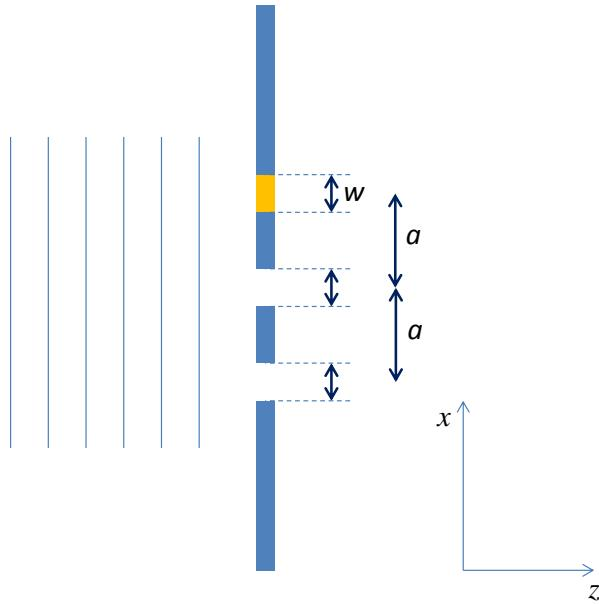
Vi har et diffraksjonsgitter bestående av tre spalter med bredde  $w$ , separert med en avstand  $a$ , slik det er skissert i figuren. En monokromatisk lyskilde (bølgelengde  $\lambda$ ) sender lys (tilnærmet planbølge) inn mot gitteret. De tre spaltene har alle samme rektangulære form som kan beskrives ved  $f_n(x) = f_0 \operatorname{rect}(x/w)$ , der  $w$  er spaltebredden og funksjonen  $\operatorname{rect}(u)$  er definert ved
