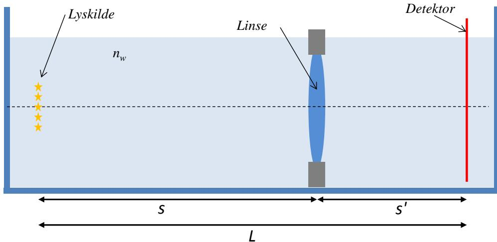
En tynn linse med fokallengde  $f > 0$  (i vann) senkes ned i et kar fylt med vann med brytningsindeks  $n_w$ . I den ene enden av karet er en lyskilde som skal avbildes, i den andre en skjerm som skal vise bildet av lyskilden, slik at avstanden fra objekt til bilde er lik  $L = s + s'$ .
