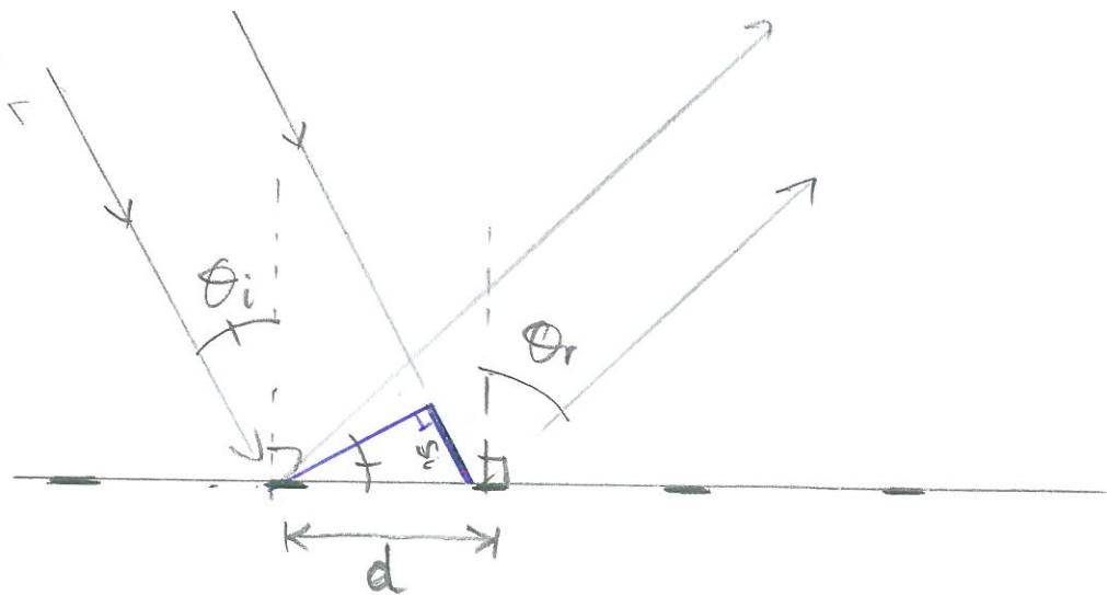
Vi ser av figuren at for inkommande nabastråler er gangveisforskjellen  $d \sin \theta_i$ , og for utgående stråler  $d \sin \theta_r$ .
