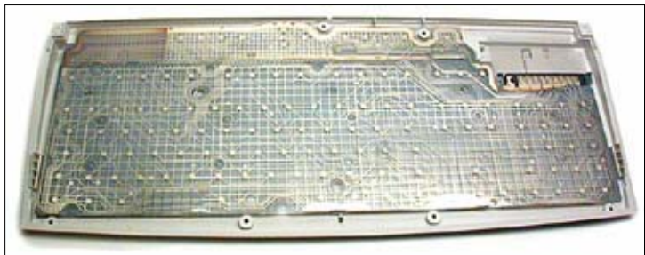
Figur 8; Koordinatsystemet inne i et tastatur.
