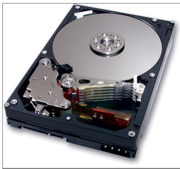
Figur 24; Dette er en helt vanlig harddisk. Man kan se lese- og skrivehoder og at det er 6 av dem. Dette betyr at det ligger til sammen 3 plater/skiver oppå hverandre.
