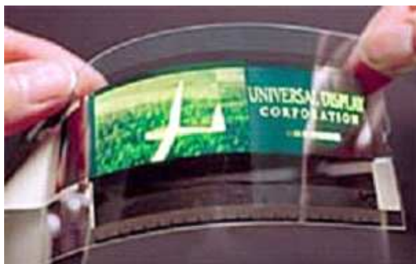
Figur 5.4: Et eksempel på en skjerm laget av organisk lysemitterende dioder, fra Universal Display Corp.
