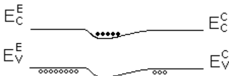
Figur25: Energibånd for transistor ved metning.
