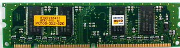
Figur 21 : her er et bilde av en vanlig DRAM-modul som de fleste datamaskiner i dag bruker.
