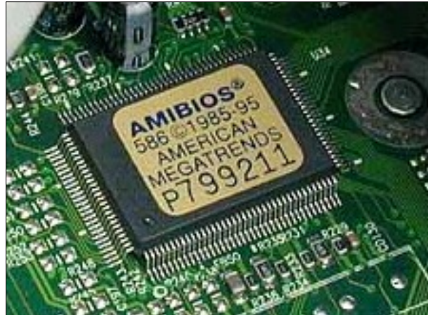
Figur 23; Her er en ROM-brikke som finnes i alle datamaskiner i dag på hovedkortet. Den har navnet "BIOS"
