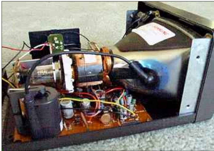
Figur 31; Innmaten i en vanlig CRT-skjerm. Man kan skimte de to spolene av kobbertråd.
