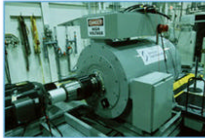
Figur 8.2: En motor basert på superlederteknologi. (Kilde: www.fysikknett.no )
