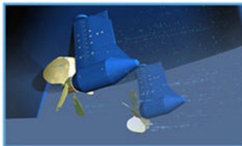
Figur 8.3: Små (super)elektromotorer på undersiden av et skip
