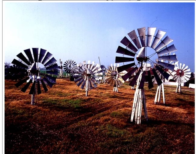
Figur 4 - Vindroser i California roterer saktere enn de danske propellene, med flere blader. 3
