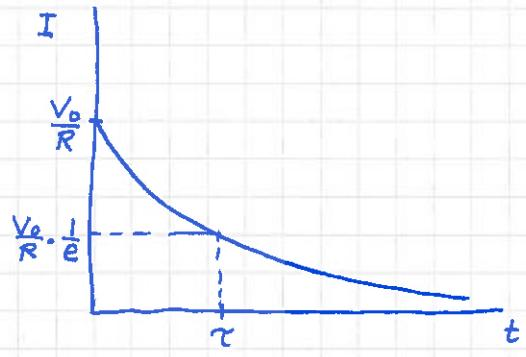
Utlading av en oppladet kondensator i en RC-krets (uten andre komponenter som spenningskilde etc) blir enda enklere:
