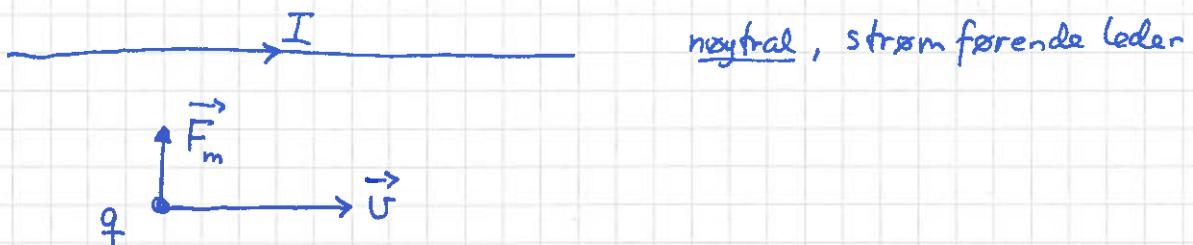
Dvs: Ladningen  $q$ , som har hastighet  $\vec{v}$ , trekkes mot den nøytrale  $\Rightarrow$  strømførende ledneren, med kraft  $\vec{F}_m$ !
