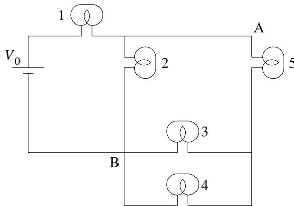
Hver av de fem lyspærene kan betraktes som en ideell ohmsk motstand  $R$ . Økt spenning over en lyspære (og dermed økt strømstyrke) gir økt lysstyrke i lyspæra. I hver av oppgavene 6 – 8 spørres det etter en eventuell endring når vi starter med kretsen slik den er vist i figuren.
