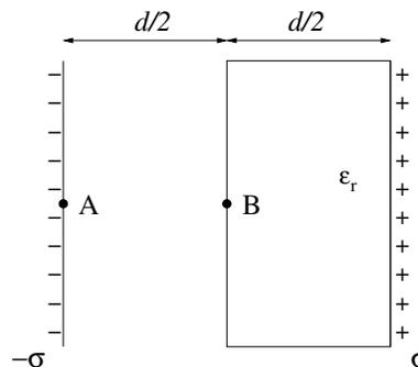
21) En parallellplatekondensator har metallplater med stor lineær utstrekning i forhold til avstanden  $d$  mellom platene. Hver plate har areal  $A$ . Den venstre tredjedelen av volumet mellom platene er fylt med et dielektrikum med relativ permittivitet 4, som vist i figuren. Resten av volumet er luft. Hva blir kapasitansen til denne kondensatoren? (Tips: Dette kan betraktes som en parallellkobling av to kondensatorer.)
