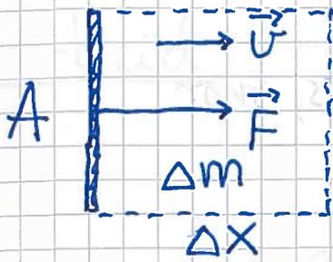
Må dytte med kraft  $F$  for å holde konstant fart  $v$ , fordi luftmassen  $\Delta m = \rho \Delta V = \rho A \Delta x$  endrer sin fart fra 0 til  $v$  i løpet av  $\Delta t = \Delta x / v$
