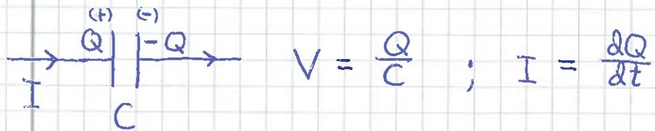
Oppplading av kondensator i RC-krets:
