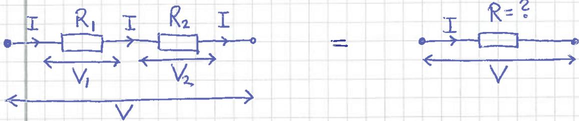
Lik strøm I gjennom de to motstandene
