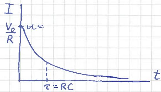
RC-kretsens tidskonstant:  $\tau = RC$  = karakteristisk tid for opplasting (og utlading) av kondensator i en RC-krets
