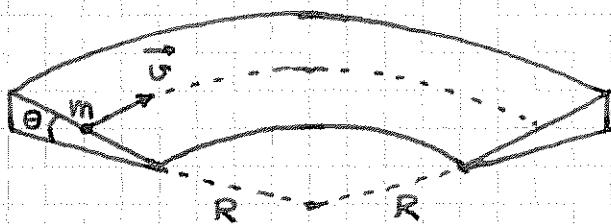
$\theta$  = doseringsvinkel $R$  = krumningsradius $m$  = bilens masse $\mu$  = statisk friksjonskoeff. (gummi / asfalt)Oppg: Finn  $v_{min}$ ,  $v_{max}$  slikat bilen ikke glir hhv inn, ut. ( $\Rightarrow$  uniform sirkelbeveg.)Finn og skisser  $N(v)$  og  $f(v)$ .
