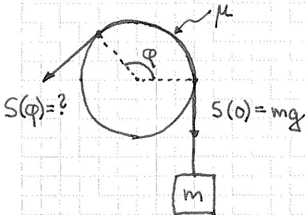
Demo (med PVC-rør, hyssing og lodd) viser at påkrevd snordrag for å holde lodd opp, øvt heise opp lodd, avhenger sterkt av  $\phi$ , dvs vinkel med kontakt mellom tau og sylinder. Finn  $S(\phi)$ .
