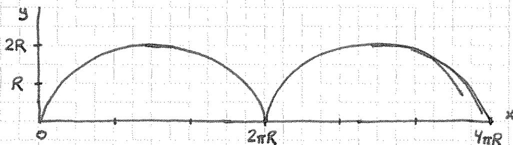
$$\dot{x} = V - \omega R \cos \omega t, \quad \dot{y} = \omega R \sin \omega t$$
