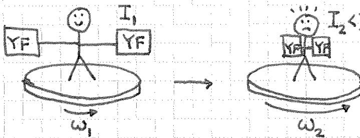
$$I_2 < I_1, \vec{\tau}_{\text{ytre}} = 0 \Rightarrow \vec{L} = \text{konst.}$$
