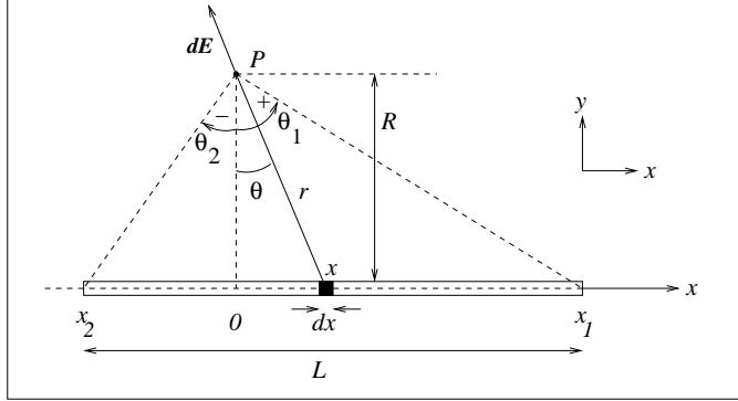
b) Elektrisk felt fra lengdeelement  $dx$  i posisjon  $x$ :
